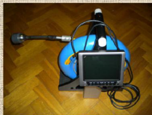
ISPEZIONI CON TELECAMERA DA FORO \phi MIN FORO O TUBAZIONE= 55 mm
