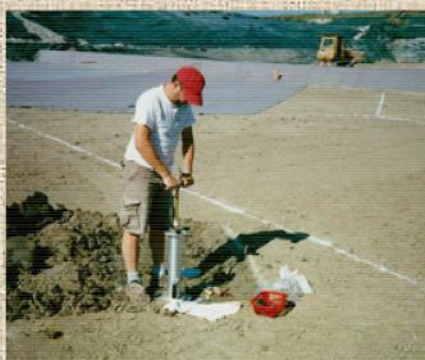
VERIFICA DENSITA' IN SITU E PROVE DI CARICO SU PIASTRA PER RILEVATI IN TERRA O GRANULARI
