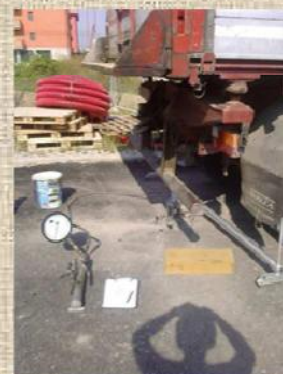
VERIFICA DENSITA' IN SITU E PROVE DI CARICO SU PIASTRA PER RILEVATI IN TERRA O GRANULARI
